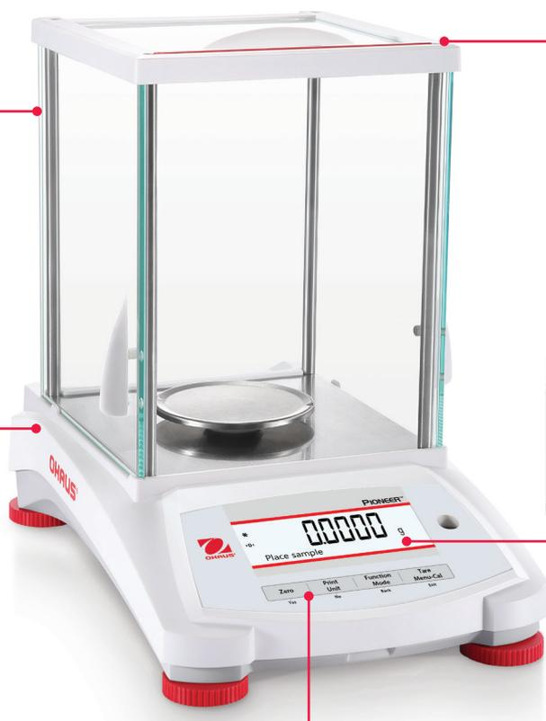
Une barre antistatique (munie d'un ABS dissipateur d'électricité statique permanent) fournit un emplacement pratique pour la mise à la terre.
